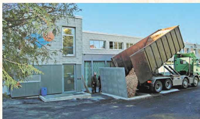
Déchargement des plaquettes de bois pour le chauffage à distance de la piscine et des serres de la Karma.
