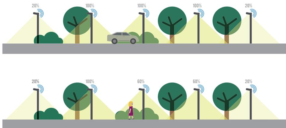
Communication entre les luminaires afin d'adapter l'intensité lumineuse.
