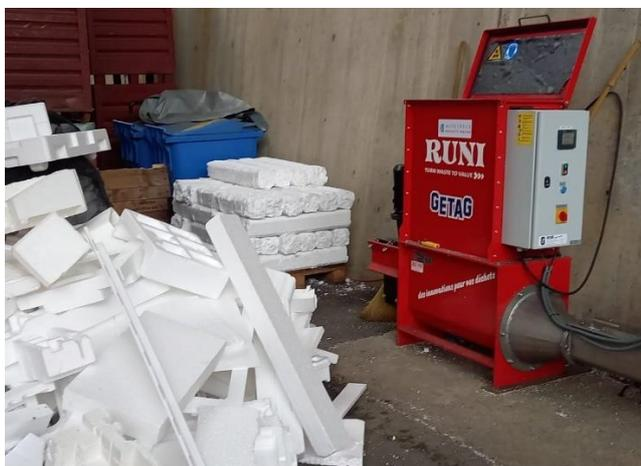
*La déchèterie est désormais équipée d'une machine permettant de compresser le polystyrène expansé.*
