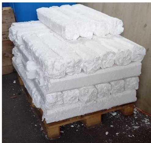
*Une palette de pain de 0.5 m<sup>3</sup> correspond à plus de 20 m<sup>3</sup> de polystyrène expansé en vrac.*
